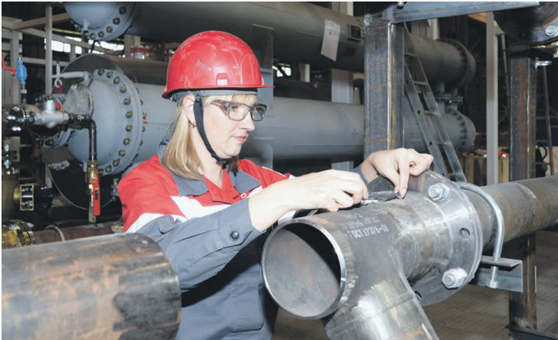
△ В цехе по производству блочно-модульных конструкций № 4 идет сборка установки отбензинивания газа © МАКСИМ КУЛИКОВ
